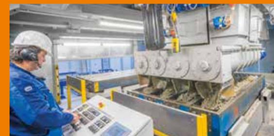
**Effiziente Anlagen: An 11 Standorten werden mehr als 250 verschiedene Schwellentypen produziert. Die Produktionskapazitäten liegen pro Jahr bei bis zu 750.000 laufende Meter Weichenschwellen und 5 Millionen Schwellen für Achslasten von bis zu 36 Tonnen und mehr.**
