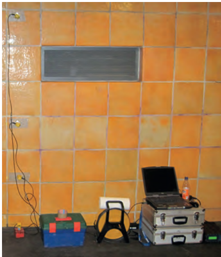
Abb. 11: Schwingungsmessung mit Geofonen im Bahnhofsbereich der U-Bahn
